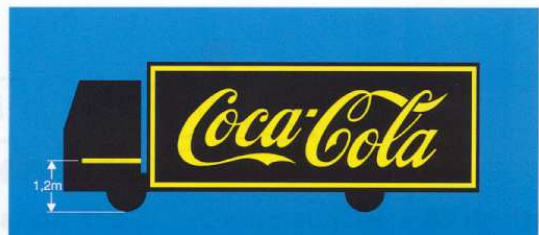
Kennzeichnung durch Konturmarkierung als Vorschlag zur Verbesserung der seitlichen Kenntlichmachung.
